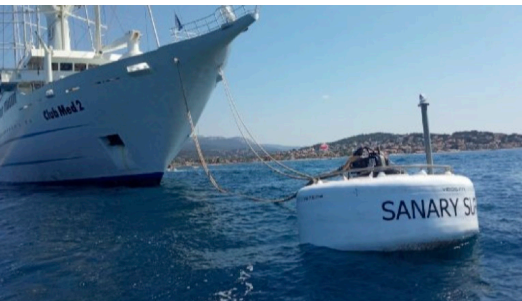
Coffre d'amarrage au profit des croisiéristes (navire < 225m) à Sanary-sur-mer
